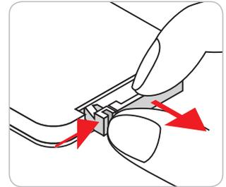
2. Inserire la nuova batteria nel vano. Rimuovere la vecchia batteria ed inserirne una nuova (CR2025). Assicurarsi che il lato con il simbolo "+" sia rivolto verso l'alto.
