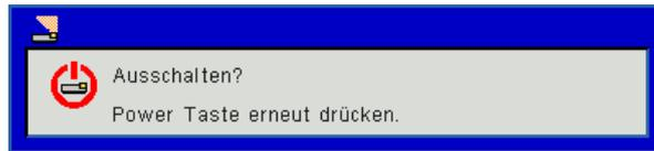
Drücken Sie zur Bestätigung erneut auf die „⏻“ Taste. Ansonsten wird die Meldung nach 10 Sekunden ausgeblendet. Wenn Sie die „⏻“ Taste das zweite Mal drücken, wird der Lüfter beginnen das System zu kühlen und herunterfahren.
