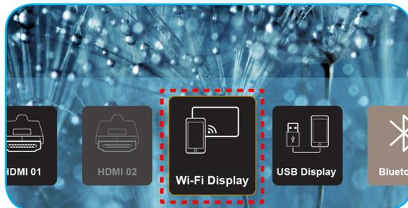
**ВАЖНО!** Для обеспечения исправной работы функции беспроводной связи аппаратный ключ Wi-Fi должен быть подключен к левому разьему USB.
