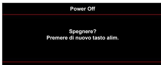
3. Premere di nuovo il tasto "⏻" o "⏻" per confermare, diversamente il messaggio scompare dopo 15 secondi. Quando si preme il tasto "⏻" o "⏻" per la seconda volta, il proiettore si spegne.
