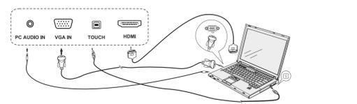
Utilice un cable VGA o HDMI, un cable USB y un cable de audio para realizar la conexión entre un equipo externo y el panel plano interactivo. Cuando ambos dispositivos estén conectados, se podrá utilizar la funcionalidad táctil.
